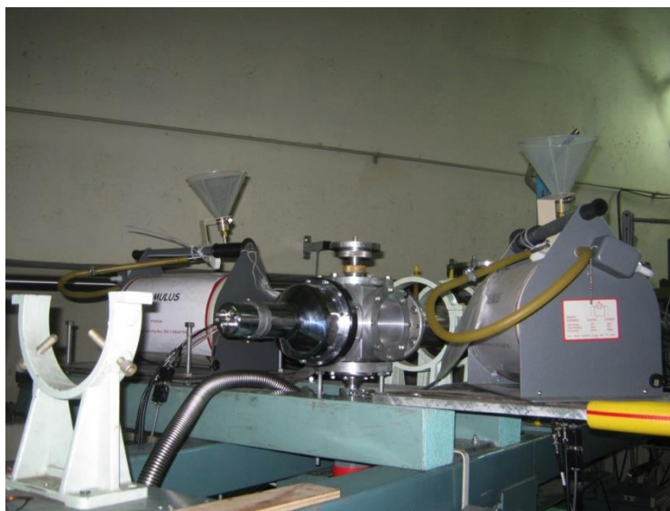
Figura 5. Sistem de detecție destinat studiilor de tip PIXE.
