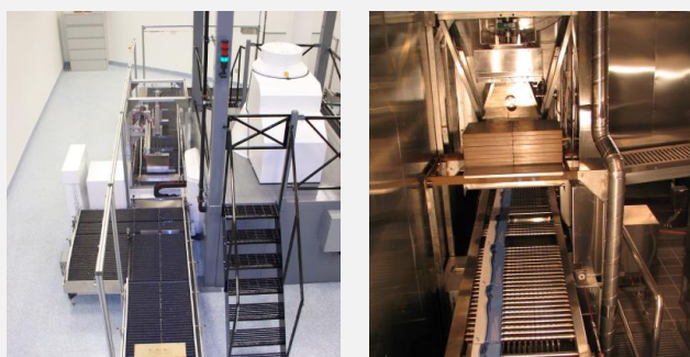
Fig. 11 Accelerator de electroni autoecranat (movibil) de 6 MeV (echivalent cu ~ 500kCi de surse de Cobal-60)
