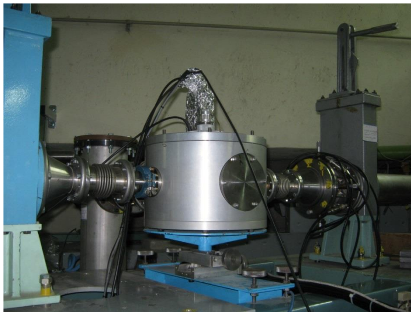
Figura 3. Camera de reacție destinată studiilor de tip ERDA și RBS.
