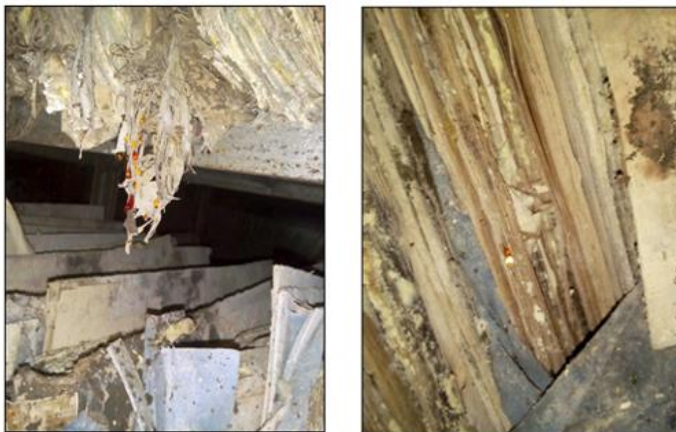
Fig. 14 Arhiva SAHIA Film, inspectata la locul de depozitare, inainte de iradiere; se observa numeroase colonii de mucegai si picaturi de gutatie (indicator de umiditate crescuta, atac activ si competitie acerba pentru substrat)
